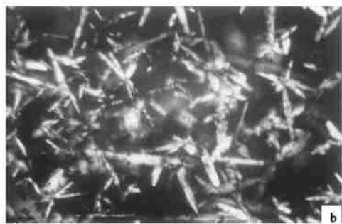
图 2 主链液晶高聚物(a) 和其悬链带磺酸离子的主链液晶高聚物(b) 在浓硫酸中的偏光照片
